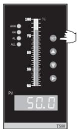
在PV显示AH的状态下，按压SET键，PV显示上限报警设定参数的设定值。
