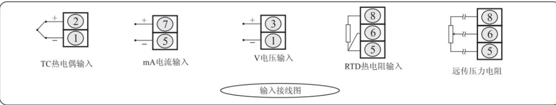
72X72X110mm仪表端子接线图 (请以仪表端子随机接线图为准)
