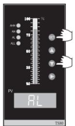
按压SET键，确认参数设定值，第一报警参数设定即告完毕，按一下减键，进入下一参数设定。
