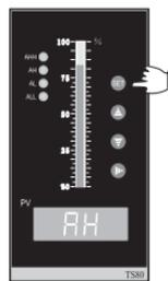
在PV显示测量值的状态下，按压SET键，屏幕显示上限报警参数符号：AH
